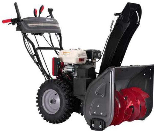
Бензиновый снегоуборщик EVOLINE SBG 610 HE (серии PREMIUM) предназначен для уборки как свежеснегавшего, так и плотного слежавшегося снега. На снегобрасывателе установлен двигатель HONDA серии GX. Ширина уборки SBG 610HE составляет 61 см, что позволяет легко маневрировать между препятствиями.
