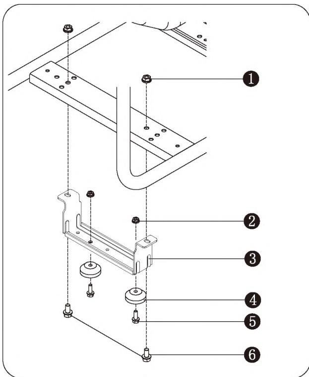
① Гайка опорного кронштейна M8
