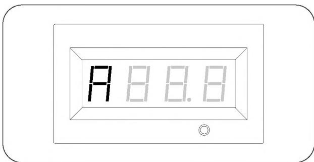
Примечание: Если отображаемое значение меньше 100, числовое отображение будет выполнено с точностью до одного знака после запятой. Если время работы составляет 100 часов или больше, на дисплее отобразятся цифры «101», «102» и так далее.
