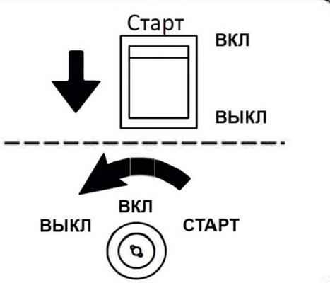
3. Поверните топливный клапан в положение «ВЫКЛ.».
