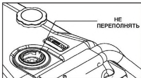
Рисунок 6. Максимальный уровень заполнения топливного бака.
