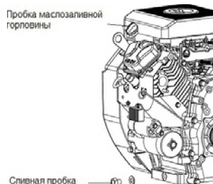
Рисунок 3. Проверка уровня моторного масла.
