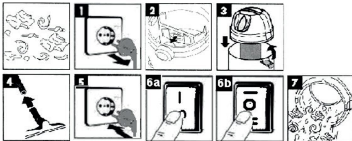
Перед заменой фильтра выньте вилку из розетки (рис. 1), затем выньте мешок и вытряхните пыль или замените мешок. Наденьте мешок для сбора пыли на входной патрубок (рис. 2).
